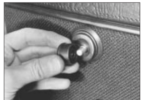
14.5 Removing door mirror adjuster knob
