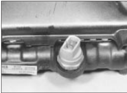
7.3 Cooling fan thermo-switch
