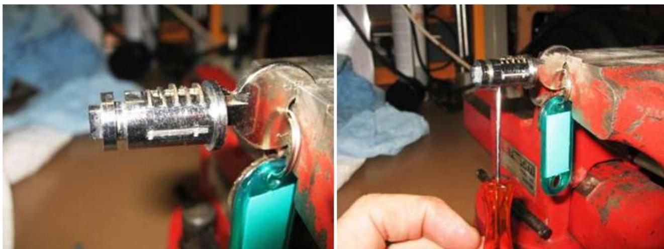
Une fois que la profondeur l'encoche est bonne je lime la clé pour créer des pentes pour faciliter l'introduction et l'extraction de la clé.
