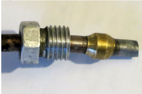
raccord 8mm x 100 de 45cc avec bicône
