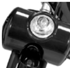
Coffre avant avec phare intégré
