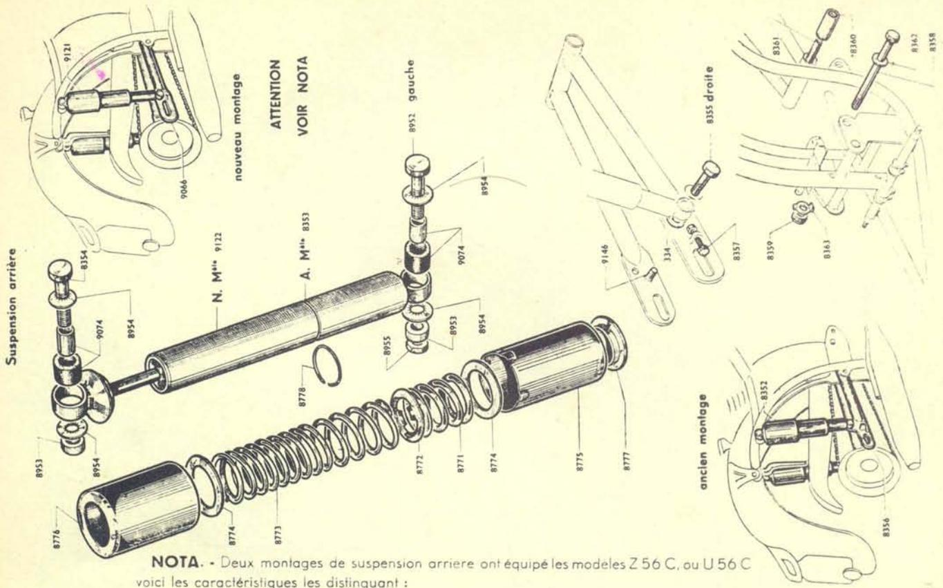
**NOTA.** - Deux montages de suspension arrière ont équipé les modèles Z 56 C, ou U 56 C
