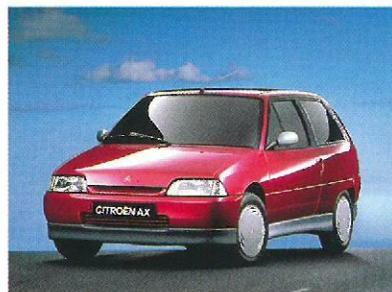
La voilà aujourd'hui détrônée par l'AX Eco qui affiche 2,9 litres aux 100 km à 90 km/heure ! Conçue sur la base de la Citroën AX Diesel "pneus verts", l'AX Eco bénéficie des réflexions des ingénieurs du bureau d'Etudes sur les principales résistances générant la consommation afin d'en réduire au minimum les effets. Sa couleur ? Rose vitamine !
