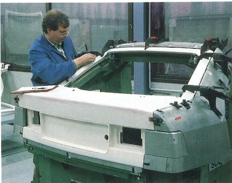
Les Maquettes de Présentation des Extérieures (MAPEX) ont permis d'assurer un assemblage et un contrôle optimal de la qualité des extérieurs de Xantia.
