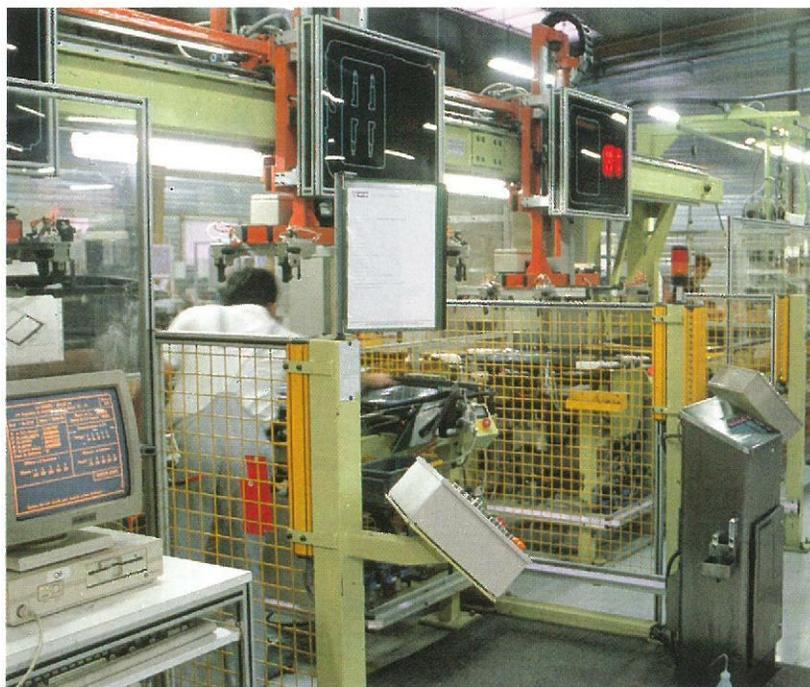
ouvrant avec un contrôle systématique en fin de chaîne. Par exemple, sur la chaîne des toits ouvrants destinés à la Citroën ZX, l'autocontrôle est automatique et permanent sur tous les éléments du toit. Les pièces bonnes sont identifiées par un code barre, en bout de chaîne.
