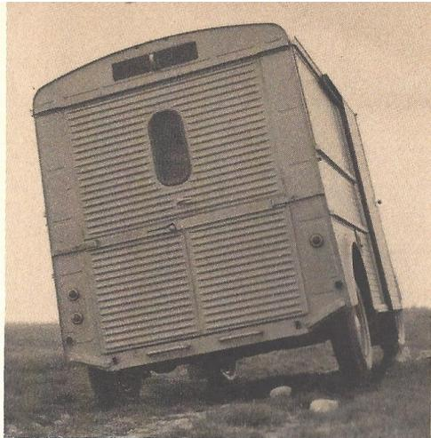
*Démontrez cette rigidité :* Quand vous placez le véhicule en déséquilibre, une roue avant montée sur un trottoir, la plateforme-plancher du H refuse de se mettre en "hélice".
