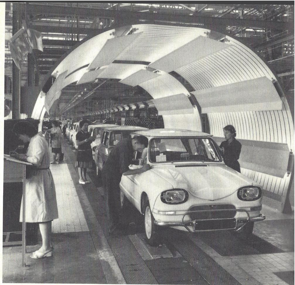
**11** La ligne d'équipement du châssis est elle aussi approvisionnée par un convoyeur aérien dont l'avancement est synchronisé avec celui de la chaîne. Cette chaîne, de type spécial, a été étudiée pour permettre une circulation facile autour des voitures et favoriser l'accès aux organes à monter.
