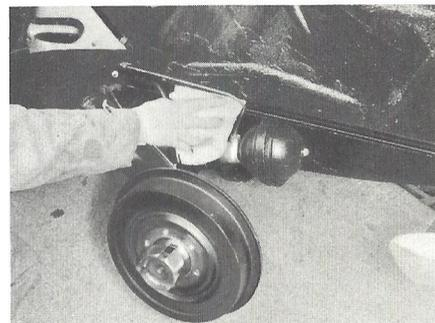
Essayer convenablement les pièces pour éviter d'introduire de l'eau dans le cylindre ou le bloc pneumatique au moment de la dépose de ce dernier (photo n° 2 et 2 bis).
