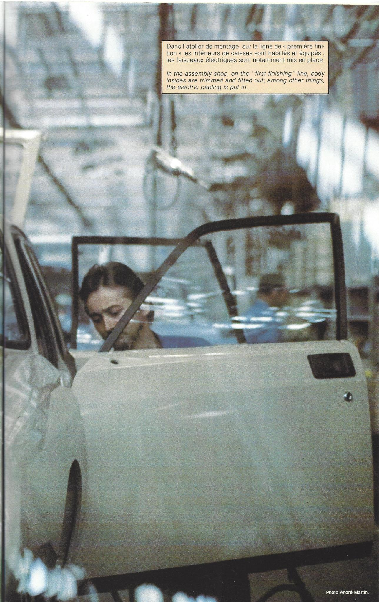
Dans l'atelier de montage, sur la ligne de « première finition » les intérieurs de caisses sont habillés et équipés ; les faisceaux électriques sont notamment mis en place.
