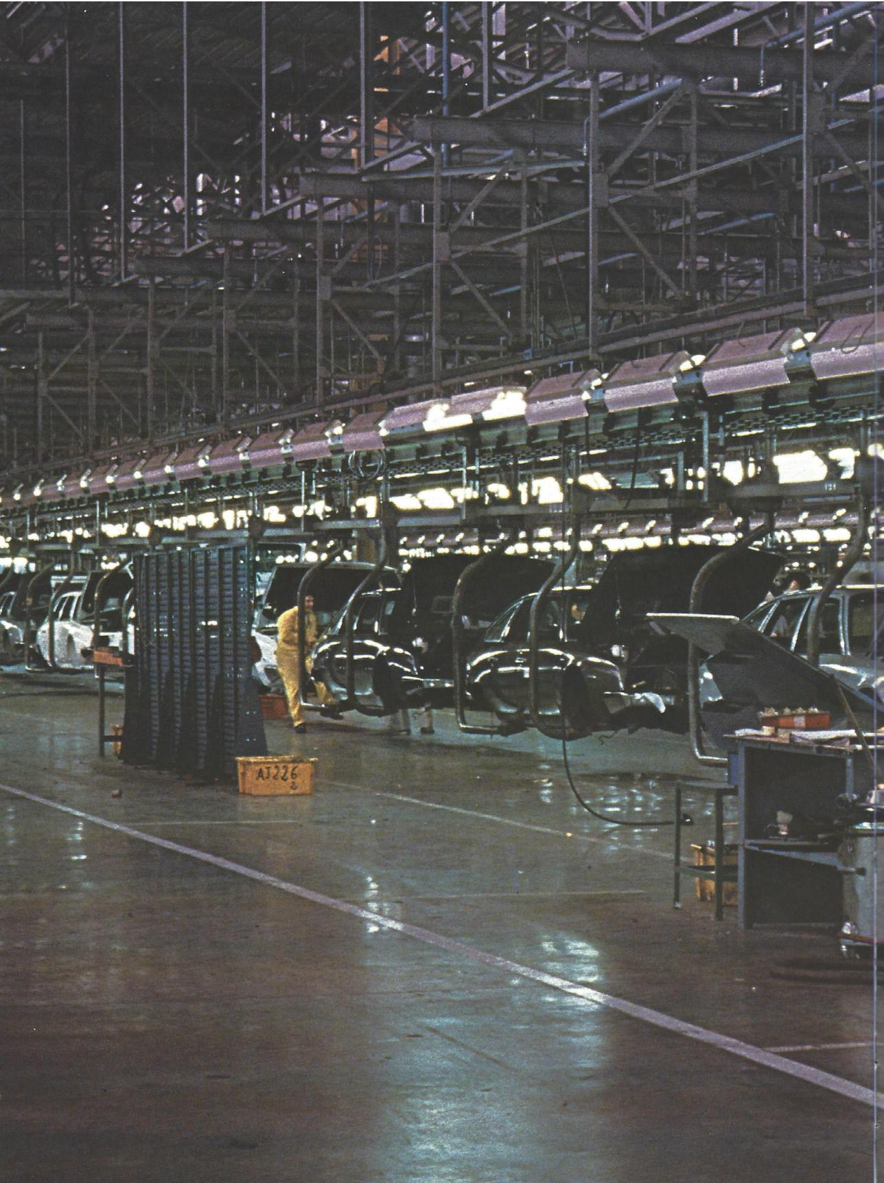
Montage : zone de contrôle en fin de ligne de première finition (habillage intérieur des carrosseries, montage des faisceaux électriques, de la console et de la planche de bord, des glaces, etc.). La voiture recevra roues, calandre, moquette, siège et branchement électrique en seconde finition. A Aulnay les contrôleurs sont tous vêtus de jaune, les opérateurs en vert, la maintenance des installations en marron.
