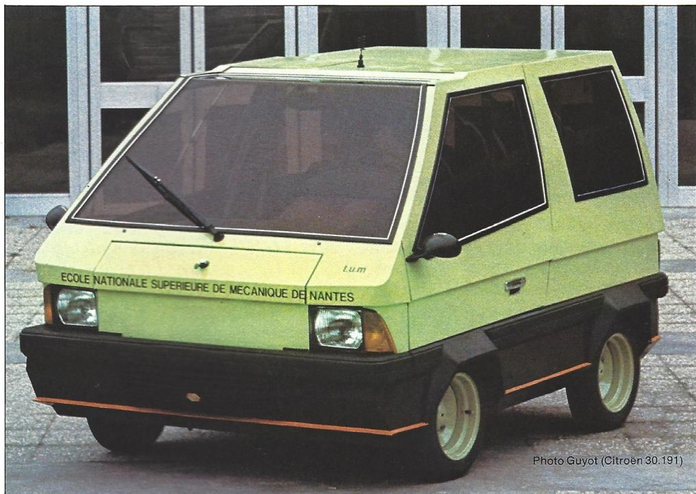
Cet ingénieux petit véhicule est un exercice de style réussi : il a été entièrement conçu et réalisé en 1978, à partir d'éléments mécaniques Citroën, par MM. Marc Lemaire et Charles Agaise, maîtres-assistants au laboratoire Moteurs et mécanismes du Département «Technologie et Techniques de production» de l'Ecole Nationale Supérieure de Mécanique de Nantes, assistés de MM. Mace, technicien, Crac et Lucas, professeurs techniques, et des élèves-ingénieurs de 2<sup>e</sup> et 3<sup>e</sup> année.
