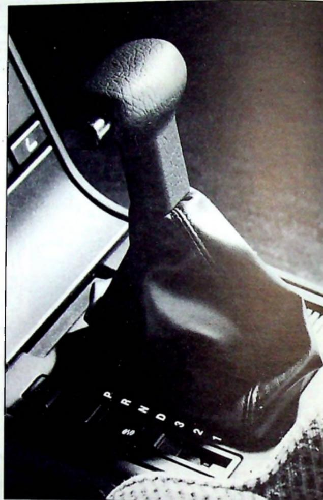
● **Position de démarrage** : Le démarrage du moteur n'est autorisé que sur les positions **P** et **N**.
