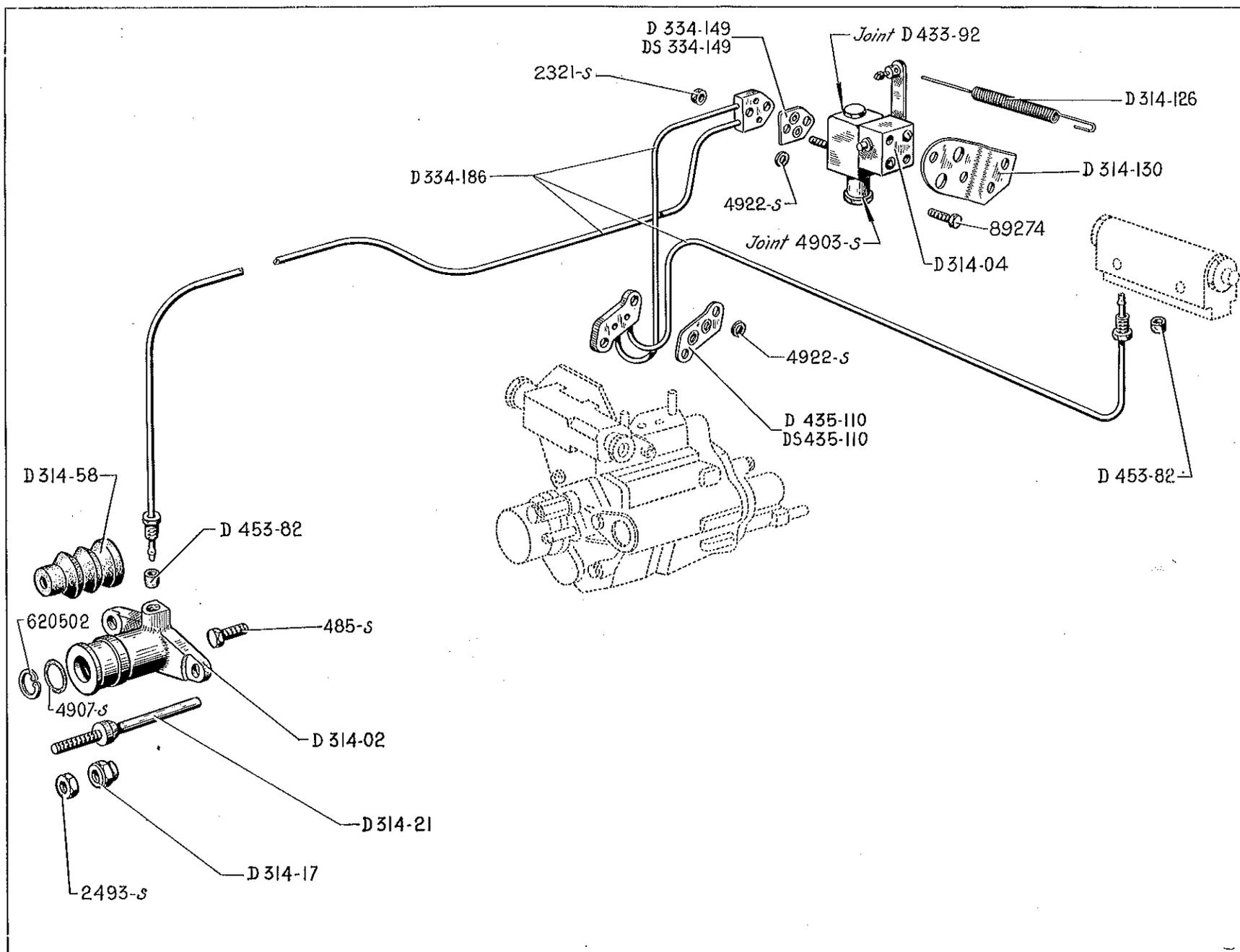
COMMANDE D'EMBRAYAGE ET CANALISATION — 53
