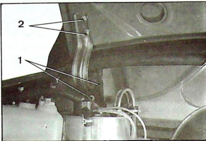
1. Agir sur les vis de fixation (1) du support de charnière pour régler la hauteur du capot par rapport au bord supérieur de l'aile avant.
