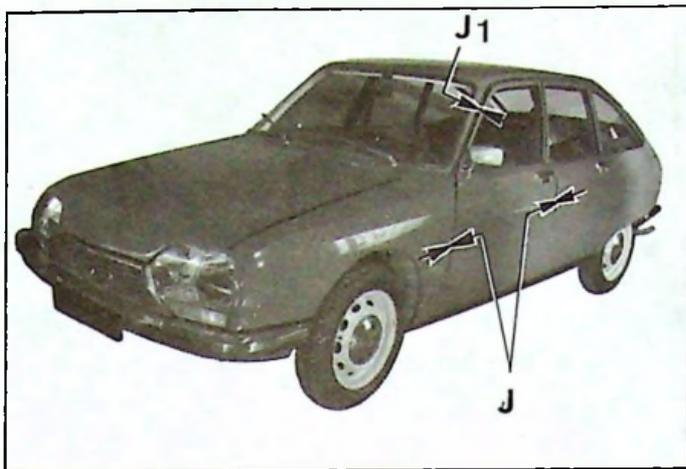
1 - Vérifier le jeu de la porte avec l'aile avant et la porte arrière qui doit être :  $J = 6 \pm 1 \text{ mm}$ .
