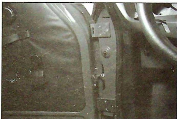
3 - Agir sur les trois vis de fixation de la gâche pour obtenir un engâchage correct et un serrage suffisant sur les caoutchoucs d'étanchéité. Si nécessaire, interposer des cales de réglage entre gâche et pied-milieu
