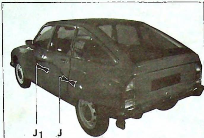
5. Vérifier le jeu  $J = 6 \begin{matrix} + 2 \\ - 0,5 \end{matrix} \text{ mm}$  entre la porte et l'aile arrière, et le jeu  $J_1 = 6 \pm 1 \text{ mm}$  entre les deux portes.
