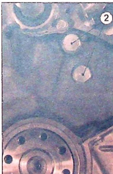
Bouchons côté volant - moteur
