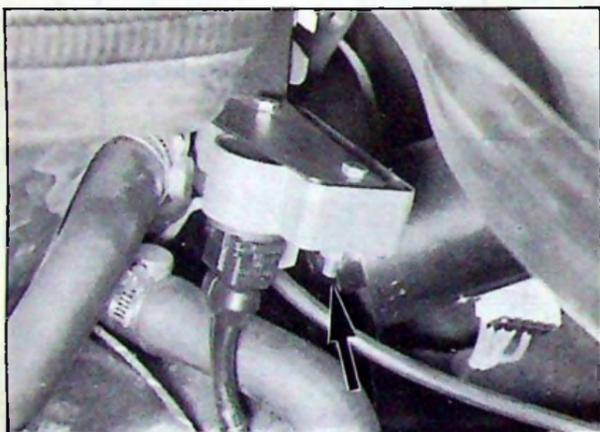
Implanté derrière la prise d'air de chauffage, il mesure la pression atmosphérique et transmet cette information au calculateur afin d'en adapter le débit injecté.
