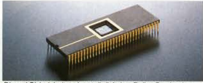
YSS-213 Yamaha Original All-Digital Dolby Pro Logic Decoding und DSP LSI
