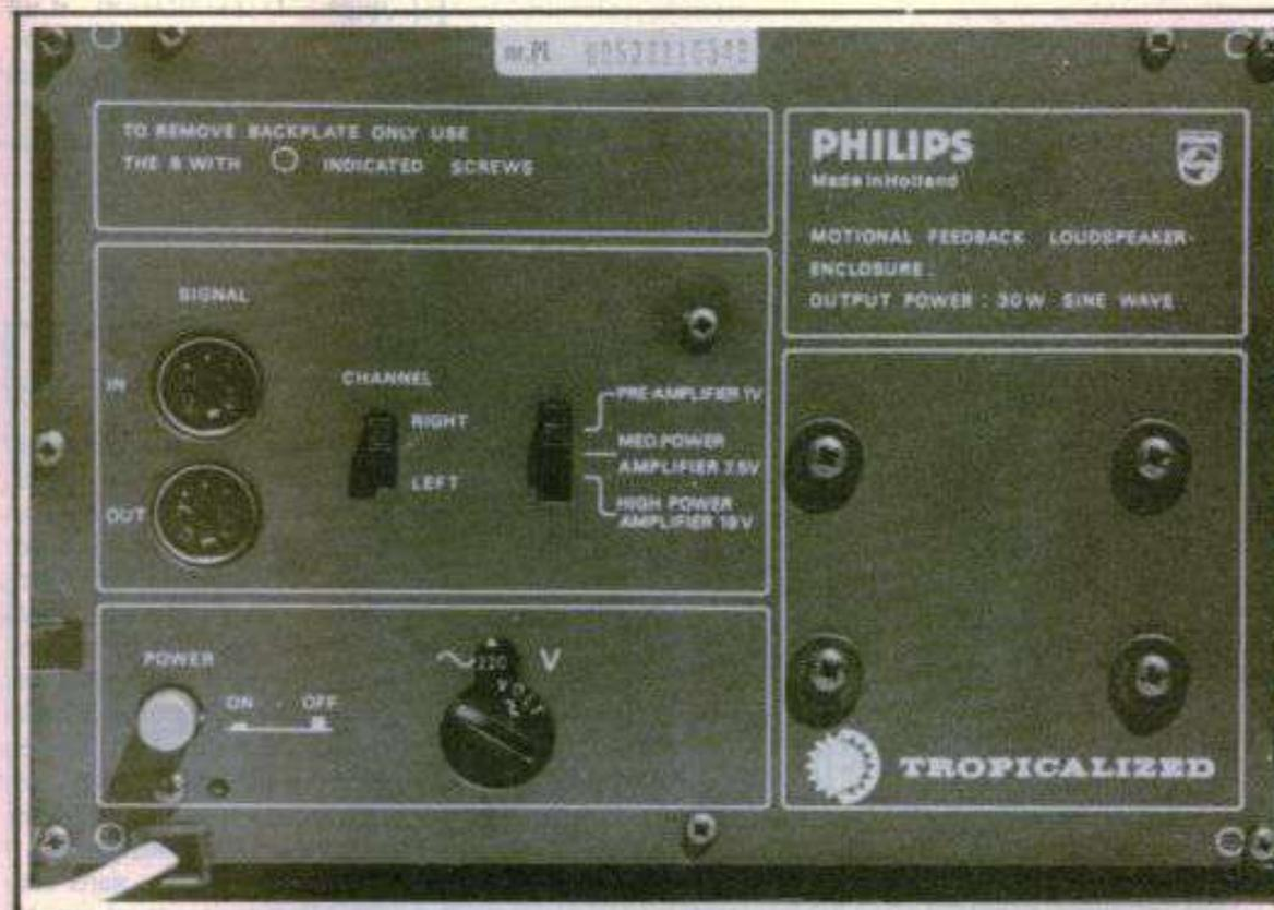
Photo 3. - La face arrière de la 541 : prise d'entrée et de sortie du signal audio, commutateur gauche/droite, sélecteur de sensibilité, sélecteur de tension et la mention « tropicalisé ».
