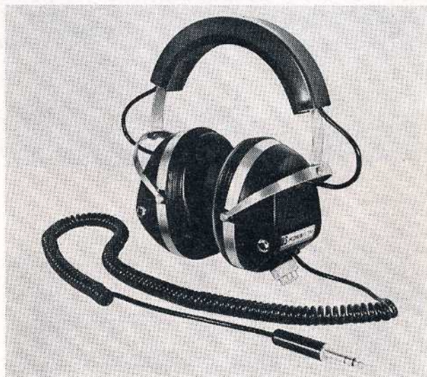
Fig. 1. — Le nouveau casque électrostatique Koss, Modèle « ESP-6 », conçu pour l'écoute stéréophonique en très haute fidélité. Equipé d'un transducteur push-pull, travaillant à charge constante pour le minimum de distorsion, il apporte une solution ingénieuse au problème de la polarisation, à tension continue relativement élevée, indispensable aux transducteurs électrostatiques.
