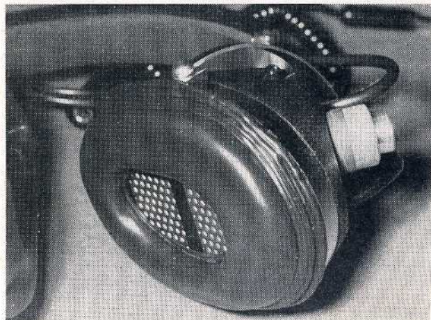
Fig. 1. — Le nouveau casque électrostatique Koss, Modèle « ESP-6 », conçu pour l'écoute stéréophonique en très haute fidélité. Equipé d'un transducteur push-pull, travaillant à charge constante pour le minimum de distorsion, il apporte une solution ingénieuse au problème de la polarisation, à tension continue relativement élevée, indispensable aux transducteurs électrostatiques.
